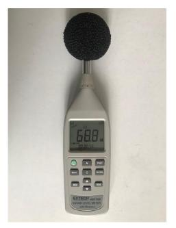
**Figure 1.** EXTECH SDL600 (Sound Level Meter) noise meter. *Şekil 1. EXTECH SDL600 (Ses Seviyesi Ölçer) gürültü ölçer.*
