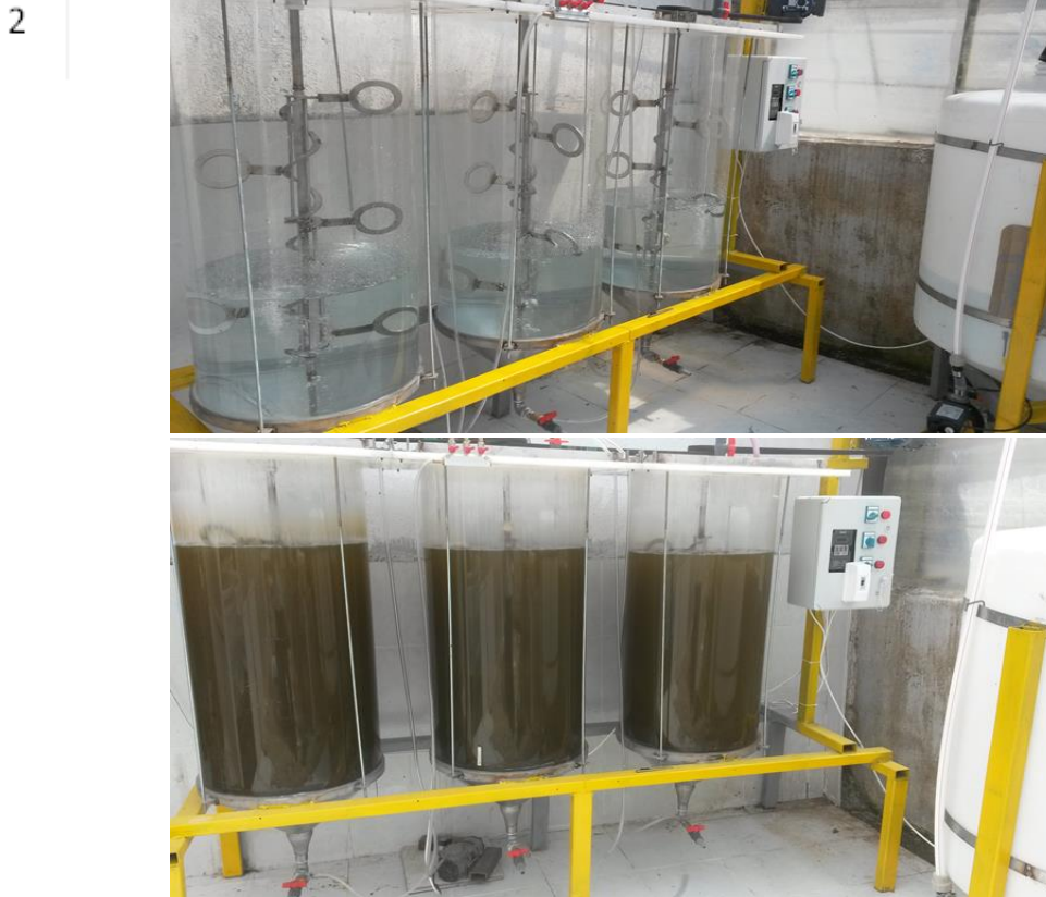
Şekil 4. Phaeodactylum tricornutum 'un yetiştirilmesi için kullanılan sistemler. (2) Suşun dikey kolon ve karıştırımlı fotobioreaktörde üretimi
